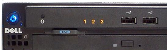
Le système contient à présent des voyants pré-POST et POST pour faciliter l'identification précise d'un problème éventuel au niveau du système.
